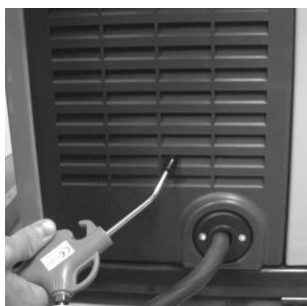
Vyfúkajte prednú časť zariadenia
