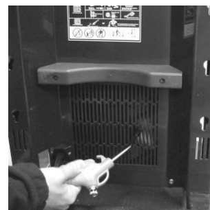
Dôkladne vyfúkajte ventilátor zariadenia
